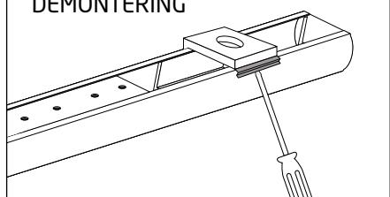
Ved demontering bruker du en flat skrutrekker. Før den inn mellom overkassen og beslaget og press skrutrekkeren nedover samtidig som du presser overkassen ned.
