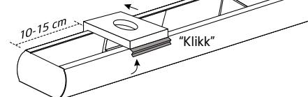
Montér overkassen ved å føre den inn i bakkant av beslagene og klikke den på plass i forkant.
